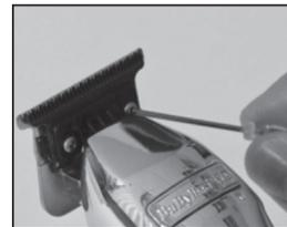
**Passo 1** – Solte levemente os dois pequenos parafusos em cada lado do jogo de lâminas com a chave de fenda fornecida.
