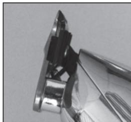
**Passo 4 – VERIFIQUE QUE A LÂMINA DE CORTE MOVEDIÇA (LÂMINA PRETA) NÃO ULTRAPASSA PARA ALÉM DA LÂMINA FIXA (LÂMINA). AVISO: SE A LÂMINA DE CORTE MOVEDIÇA (LÂMINA NEGRA) SOBRESSAI, PARA ALÉM DA LÂMINA FIXA (LÂMINA), PODE CORTAR O CLIENTE.**
