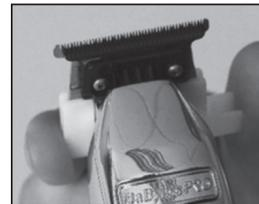
**Passo 3** – Coloque os dedos em cada lado da ferramenta de ajuste de zero e puxe para cima até que a lâmina de corte movediça (lâmina preta) esteja ao mesmo nível ou ligeiramente por baixo da lâmina fixa (lâmina).
