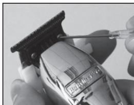
**Passo 5 –** Quando as lâminas estejam ajustadas para zero (ou o nível desejado), aperte levemente os dois parafusos em cada lado do jogo de lâminas enquanto mantém a ferramenta de ajuste a zero no seu lugar. Faça um teste de manipulação. Se as lâminas não estiverem bem ajustadas, repita o processo de ajuste.
