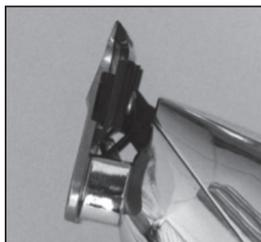
**Step 4** – MAKE SURE THE MOVING CUTTING BLADE DOES NOT EXTEND PAST THE FIXED BLADE. **WARNING: IF THE CUTTING BLADE EXTENDS PAST THE FIXED BLADE YOU CAN POTENTIALLY CUT A CLIENT.**
